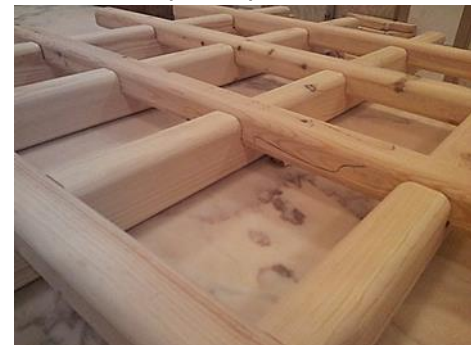
(شكل 22) يوضح بداية مرحلة التجميع للقوائم والرووس بعد الإنتهاء من مرحلة الخدش والصنفرة وهذه المرحلة كانت قاصرة على الطلاب وتعرف تلك العملية بـ "تركيبية نصف على نصف" وهي من أبسط الطرق للتثبيت في علم تكنولوجيا الأثاث
